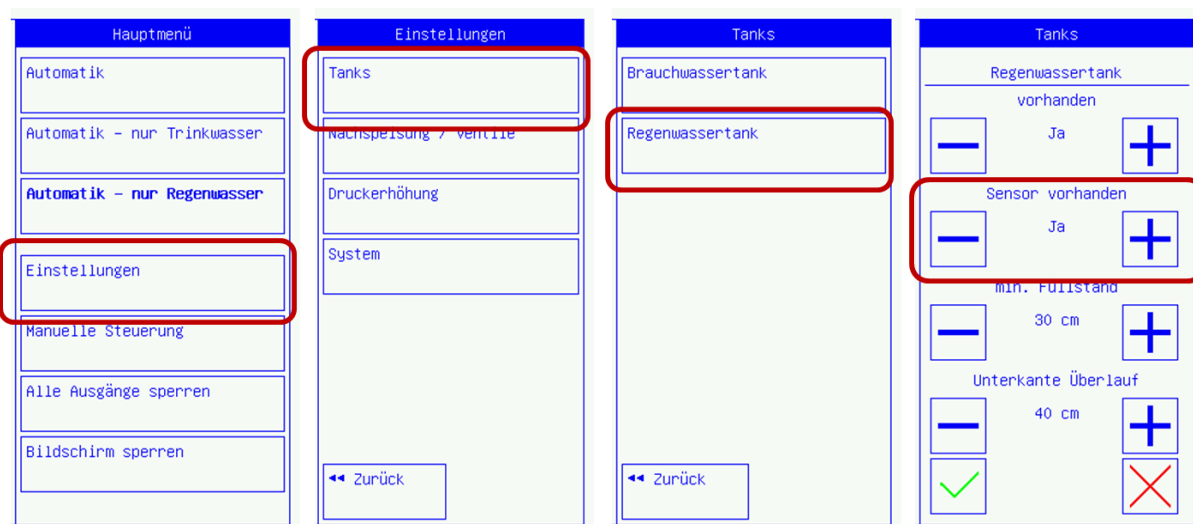
Figure 60 : Activation du capteur pour visualiser le niveau de remplissage
