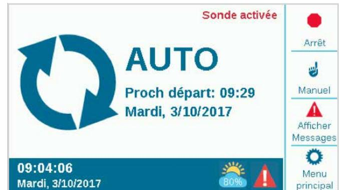
Si Solar Sync est installé et activé (menu Appareils), le symbole Solar Sync indique le pourcentage du réglage actuel dans le coin inférieur droit.
