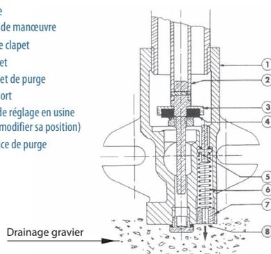
**INSTALLATION** : Il est recommandé d'éviter le contact direct de la terre avec la partie inférieure de la bouche, et de drainer l'écoulement de purge à l'aide de gravier exclusivement
